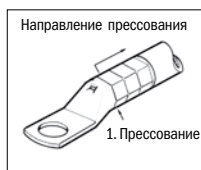
Кабельные наконечники с насечкой / трубчатые кабельные наконечники
