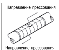
Прессованные кабельные наконечники DIN
